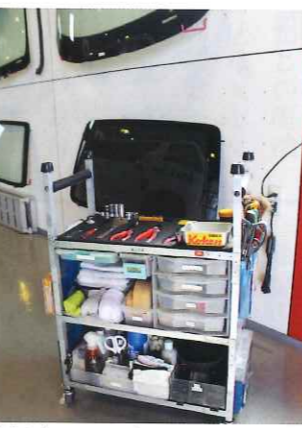
作業台車には工具類が整理されている
